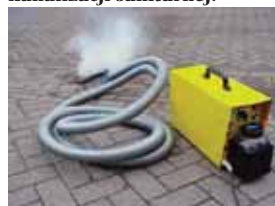
Urządzenie do zadymiania kanalizacji pomoże wykryć nielegalne podłączenia deszczówki.
