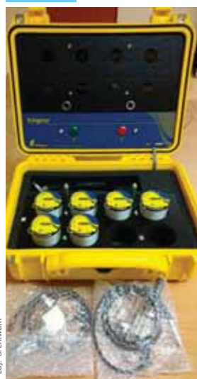
Nowoczesny korelator wskazuje miejsce wycieku wody za pomocą szumów w rurociągach. Urządzenie właśnie trafiło do GZWiK Krzyżowice.
